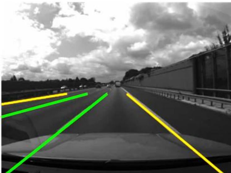
Bild 6 Fahrspurerkennung mit einem mehrzeiligen Laserscanner
