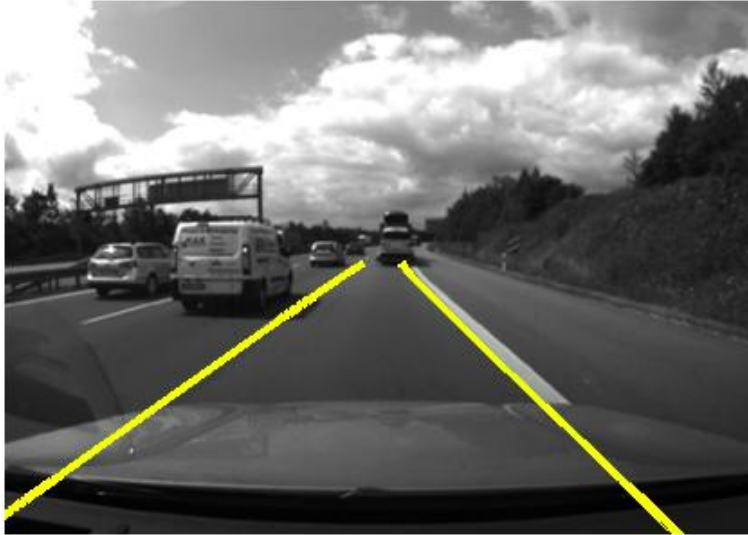
Bild 5 Fahrspurerkennung mit einer Kamera
